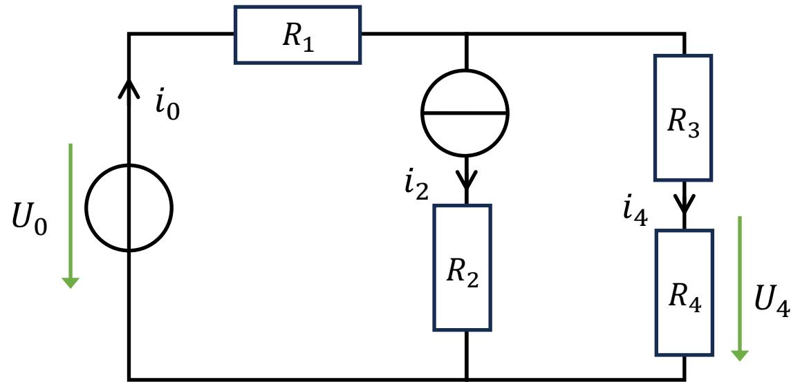
Le principe de superposition permet de séparer un problème à  $N$  sources en  $N$  problèmes à une source
