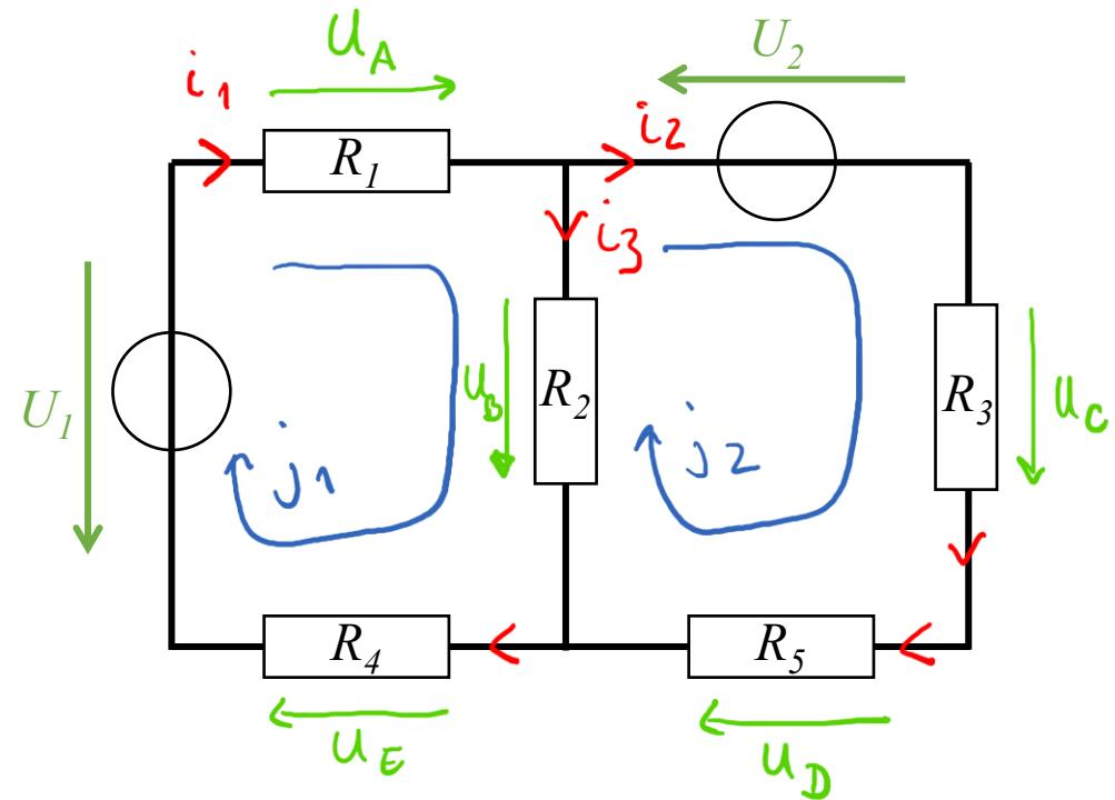
$$\begin{aligned}i_1 &= j_1 \\i_2 &= j_2 \\i_3 &= j_1 - j_2\end{aligned}$$
