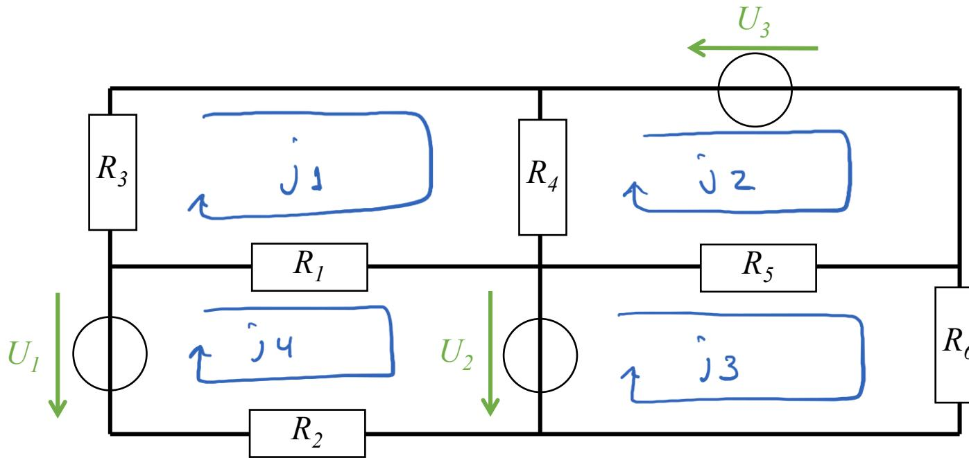
$$\begin{bmatrix} (R_1 + R_3 + R_4) & -R_4 & 0 & -R_1 \\ -R_4 & (R_4 + R_5) & -R_5 & 0 \\ 0 & -R_5 & (R_5 + R_6) & 0 \\ -R_1 & 0 & 0 & R_1 + R_2 \end{bmatrix} \begin{bmatrix} j_1 \\ j_2 \\ j_3 \\ j_4 \end{bmatrix} = \begin{bmatrix} 0 \\ U_3 \\ U_2 \\ U_1 - U_2 \end{bmatrix}$$
