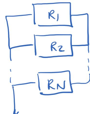
$$R_1 // R_2 \Rightarrow \frac{R_1 R_2}{R_1 + R_2}$$
