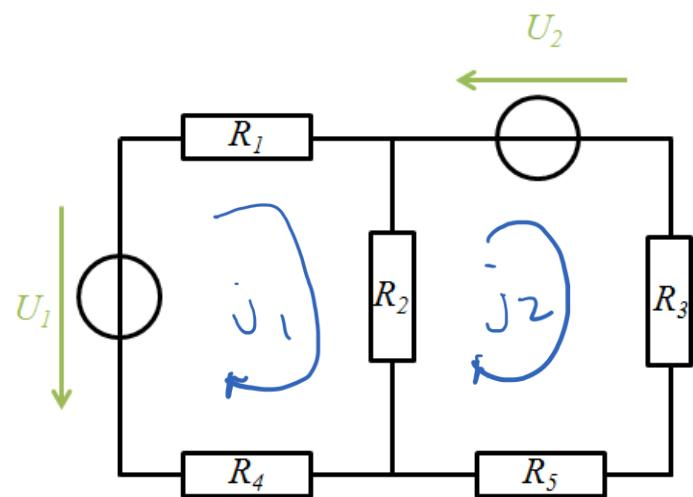
$$\begin{bmatrix} (R_1 + R_2 + R_4) & -R_2 \\ -R_2 & (R_3 + R_5 + R_2) \end{bmatrix} \begin{bmatrix} j_1 \\ j_2 \end{bmatrix} = \begin{bmatrix} U_1 \\ U_2 \end{bmatrix}$$
